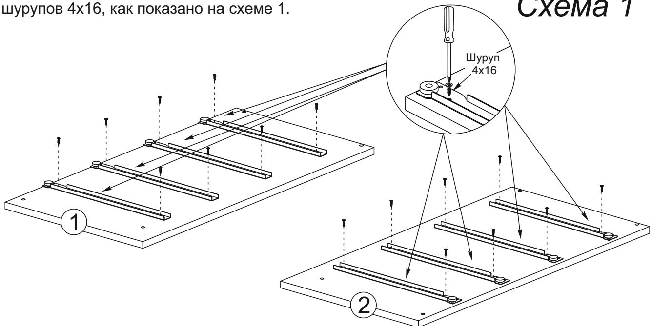
3. Соедините евровинтами боковины №1 и №2 с цоколями №6, планками №4 и №5. Закрепите крышку №3. Для этого вверните шурупы 4x25 в крышку №3 через планки №4 и №5, как показано на схеме 2.
